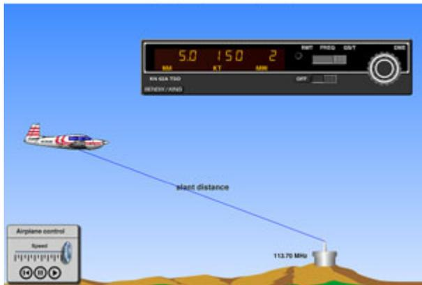
Cet appareil mesure la distance entre l'avion et la station. Il renseigne aussi la vitesse et le temps nécessaire pour rejoindre la station.
