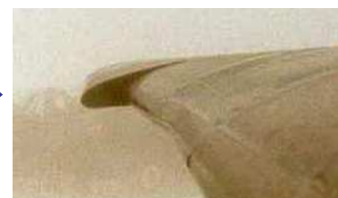
Dent de scie sur le bord d'attaque d'une aile d'Alphajet
